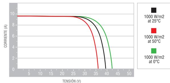
1. STC (Standard Test Condition): Irradiación 1000W/m<sup>2</sup>, Temperatura del módulo 25°C, Aire 1.5
